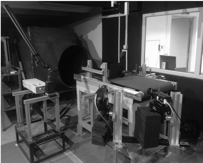
Ryc. 4. Stanowisko badawcze do wizualizacji przepływu powietrza wokół izolowanego koła samochodowego
